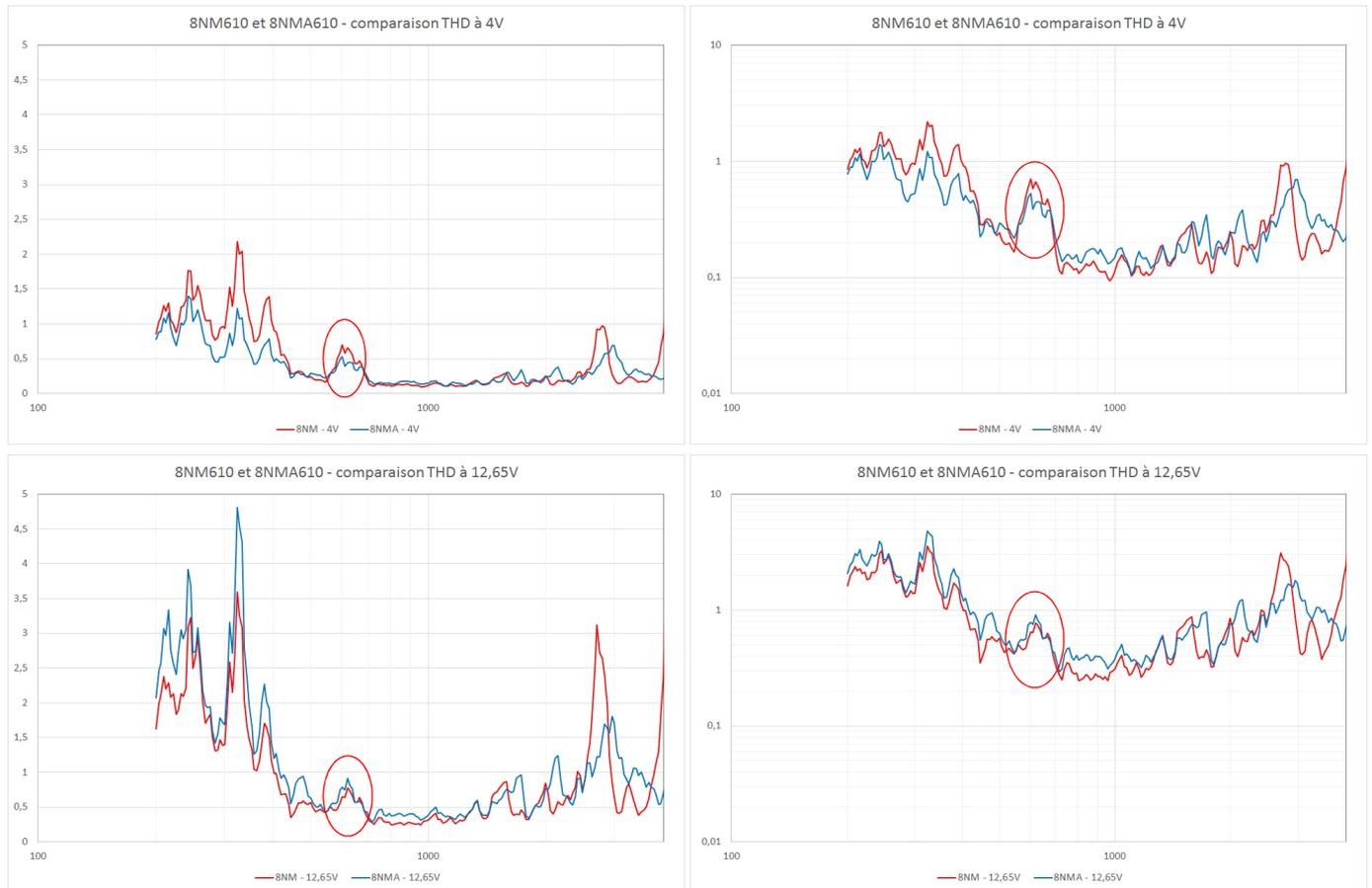
Il ne faut pas tenir compte de la "coquetterie" entourée de rouge. Elle n'apparaissait pas sur nos mesures d'octobre, et est plus probablement liée aux conditions de la mesure (HP posé sur un petit support en bois, vibrations probables).
