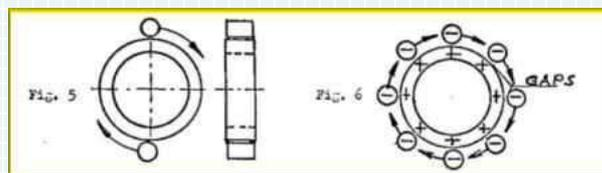
On obtient alors un effet qui se propage d'un aimant l'un à l'autre et finalement tous les petits aimants se mettent en mouvement autour de l'aimant central.
