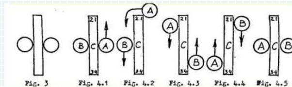
Si l'on déplace l'aimant A vers le haut ( fig 4.1 ) jusqu'à le faire passer au-dessus du haut de la barre aimantée ( fig 4.2 ), il accélère alors très rapidement en passant de l'autre côté de la barre .
