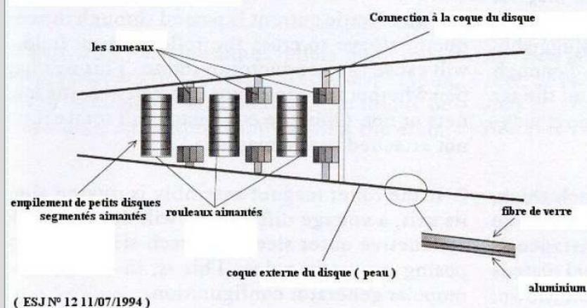
Vue en coupe d'un disque de Searl ( source ESJ n°12 traduction moumra ) On peut aussi constater que les anneaux de confinement et les rouleaux ne sont pas en contact. Cela permet d'atteindre de très hautes vitesses de rotation des rouleaux sans aucune friction.
