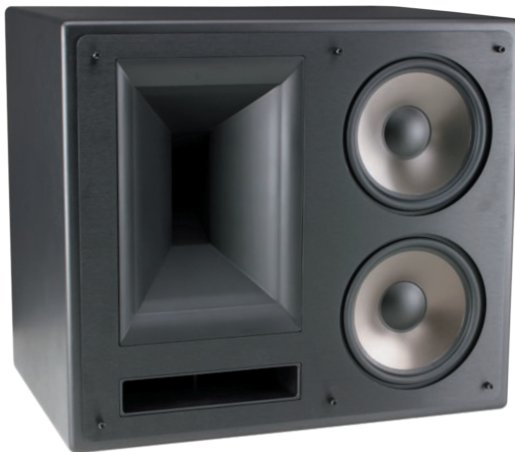
L'enceinte KL-650-THX apte à la reproduction stéréophonique traditionnelle. Deux boomers de 165 mm à membrane "Cerametallic", pavillon d'aigu et événement laminaire sous le pavillon.
